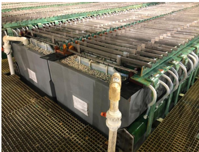
6-сурет – Балқаш металлургия зауытының қорғасын шаңын шаймалау процесінің зерттеу үшін өнеркәсіптік электролизер
